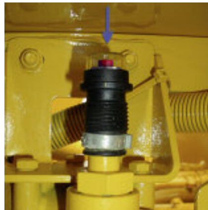
Wird bei Betriebstemperatur der Knopf gedrückt und springt wieder heraus, ist der Druckfilter verschmutzt und muss gewechselt werden
