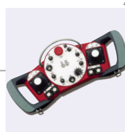
42 An der vollproportionalen Funkfernsteuerung können gleichzeitig mehrere Bewegungen mit echter Zweihandbedienung, ohne Umgreifen ausgeführt werden
