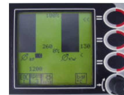
Variable Druck- und Leistungsanpassung über das EGD, z.B. für den Einsatz von Schlauchleitungen
