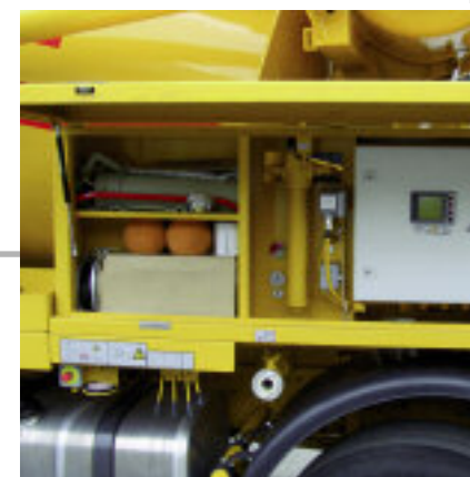
43 Im abschließbaren Modulschrank der PUMI® ist neben der hydraulischen Maststeuerung und dem Elektroschaltkasten noch ein Ablagefach vorhanden
