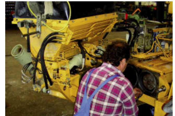
Der Trichter der CS-Kolbenpumpe wird einfach weggeklappt. Dadurch sind die Förderzylinder gut zu erreichen.
