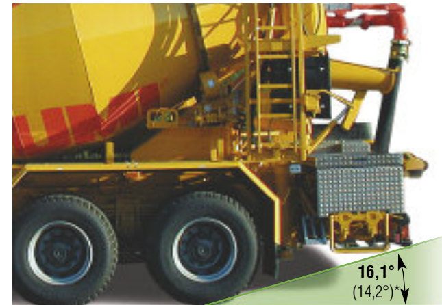
Geringer Überhang für schwer befahrbares Gelände und starke Steigungen *auf MB Actros 8x4 (Vergleichswerte eines Wettbewerbers in Klammern)
