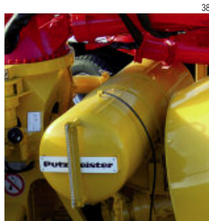
38 Für immer reichlich Wasser sorgt der große, mit Druckluft beaufschlagte 650 l Wassertank
