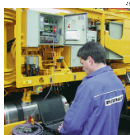
Überwachung und Parametrierung von Zustandsdaten per Ergonic® Tele Service (ETS)
